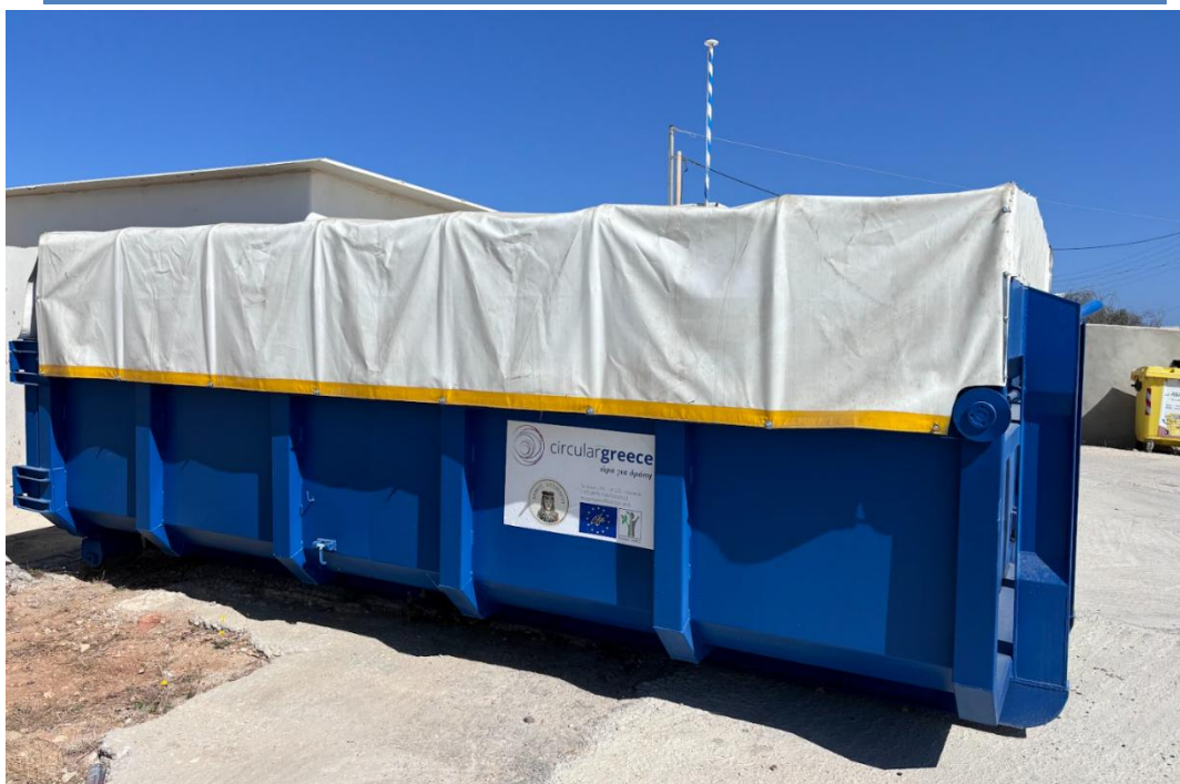
Εικόνα 5: Απορριμματοκιβώτιο ανοιχτού τύπου (open-top container) για προσωρινή αποθήκευση και μεταφορά ανακυκλώσιμων υλικών
