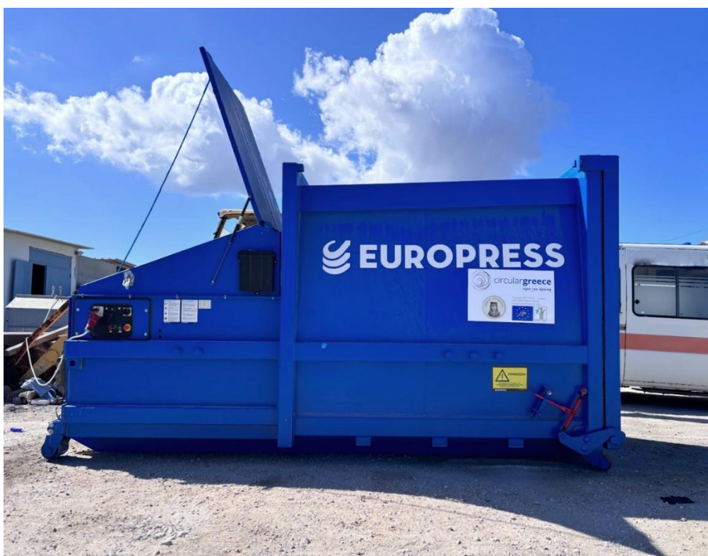
Εικόνα 6: Απορριμματοκιβώτιο συμπίεσης (Press container) τοποθετημένο στον χώρο προσωρινής αποθήκευσης του Δήμου Αντιπάρου
