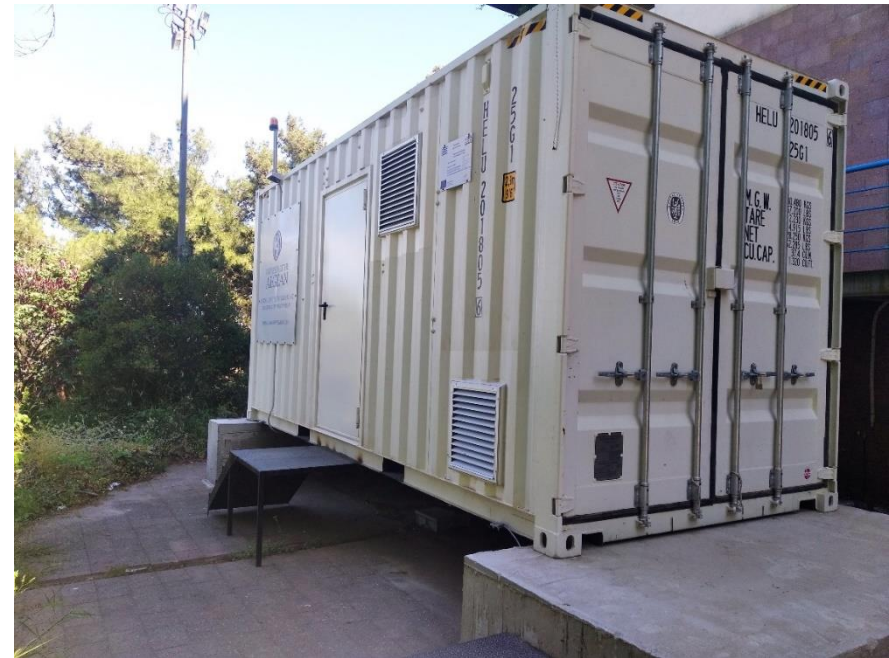
Μονάδα αναερόβιας χώνευσης πιλοτική κλίμακα (AgroWaste Lab Research Infrastructure)
